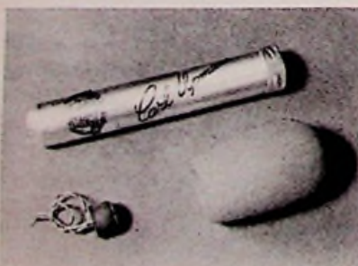
Afb. 1 Nodig zijn een kokertje van een sigaar, een elektret-microfoonkapsel, een windkapje, een stuk afgeschermd snoer en een doorvoertule.
