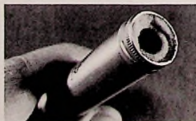
Afb. 2 Aan de achterzijde van de koker wordt een gat voor de doorvoertule geboord en de bovenkant van het deksel wordt weggesneden. Het microfoonkapsel wordt met een strook schuimrubber in het kokertje geklemd.
