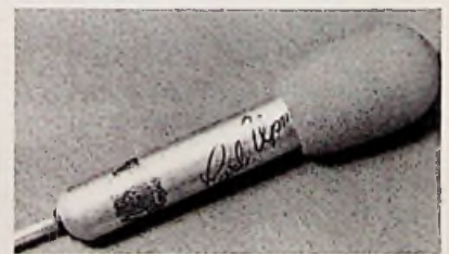
Afb. 3 De windkap erop en de microfoon is gereed.
